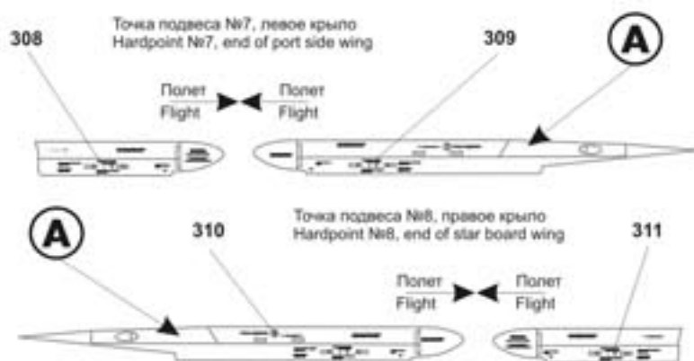
Пусковое устройство АПУ-470, точки подвеса 3 и 4 APU-470 launch rail station, hardpoints № 3 and 4
