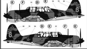
Су-2 с поздним вариантом капотирования М-88Б, серийный номер не установлен, принадлежащий неустановленному БАП из состава ВВС РККА, лето 1941 года. Самолет был подбит и совершил вынужденную посадку на территории, контролируемой противником. Окраска самолета и нанесение ОЗ ВВС РККА аналогичю (15). На самолето отсутствует тросовая антенна радиостанции.
